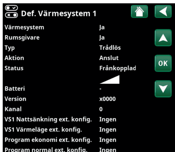
Meny "Avancerat/Definiera/Värmesystem/Värmesystem 1". Trådlös rumsgivare har valts.
