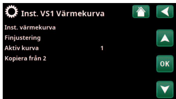
Meny "Avancerat/Inställningar/Värmesystem/ Värmesystem 1/Värmekurva". Aktiv kurva: #1.
