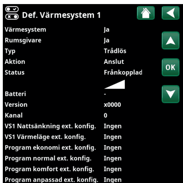
Meny "Avancerat/Definiera/Värmesystem/Värmesystem 1". Trådlös rumsgivare har valts.
