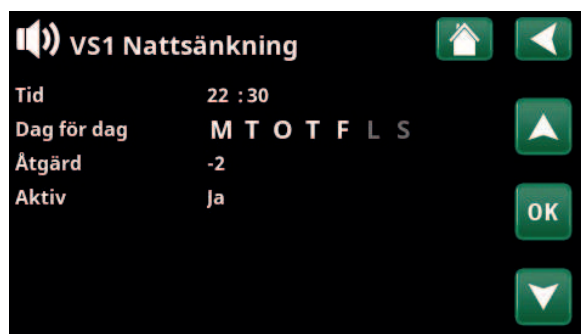
Inställning av nattsänkning (-2 °C), vardagsnätter.
