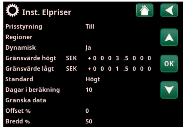
Meny "Avancerat/Inställningar/Kommunikation/Elpriser" vid val "Avancerat/Definiera/Kommunikation/myUplink:Ja".
